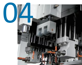
Верхняя сверлильно-присадочная голова с пазовой пилой
