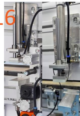
В автоматическом режиме отрывает стружку, оставшуюся после обработки радиусной циклевки.
